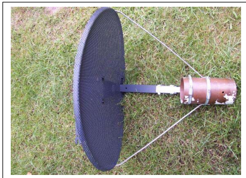
Figura BII.4: Antena de bote en una parabólica.
